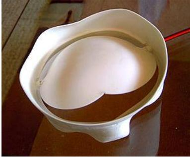
52) Auch die im Alu-Flexrohr vom Kollektor zum Bad eingesetzte 125er-Rückschlagklappe wurde durch die Hitze völlig zerstört.
