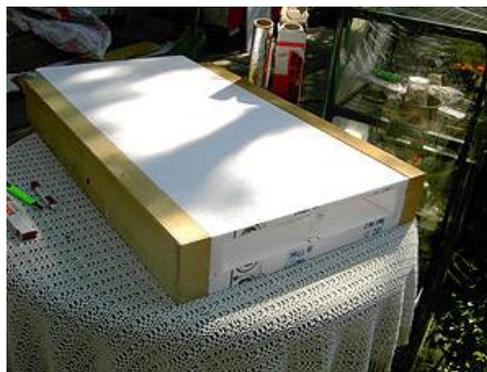
42 und 43) ...aus 4cm dicken Styropor-Platten werden Formteile ausgearbeitet...
